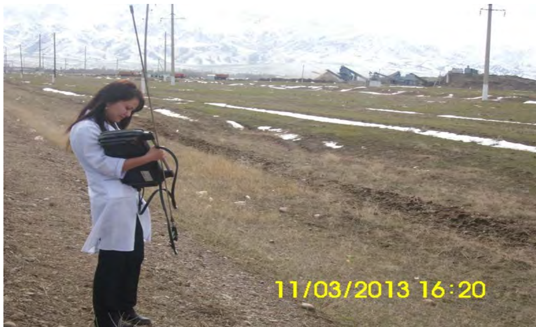
Фотография 1: Проведение инструментальных замеров атмосферного воздуха на дробильно-сортировочном комплексе “Sandvik”, 11.03.2013г.
