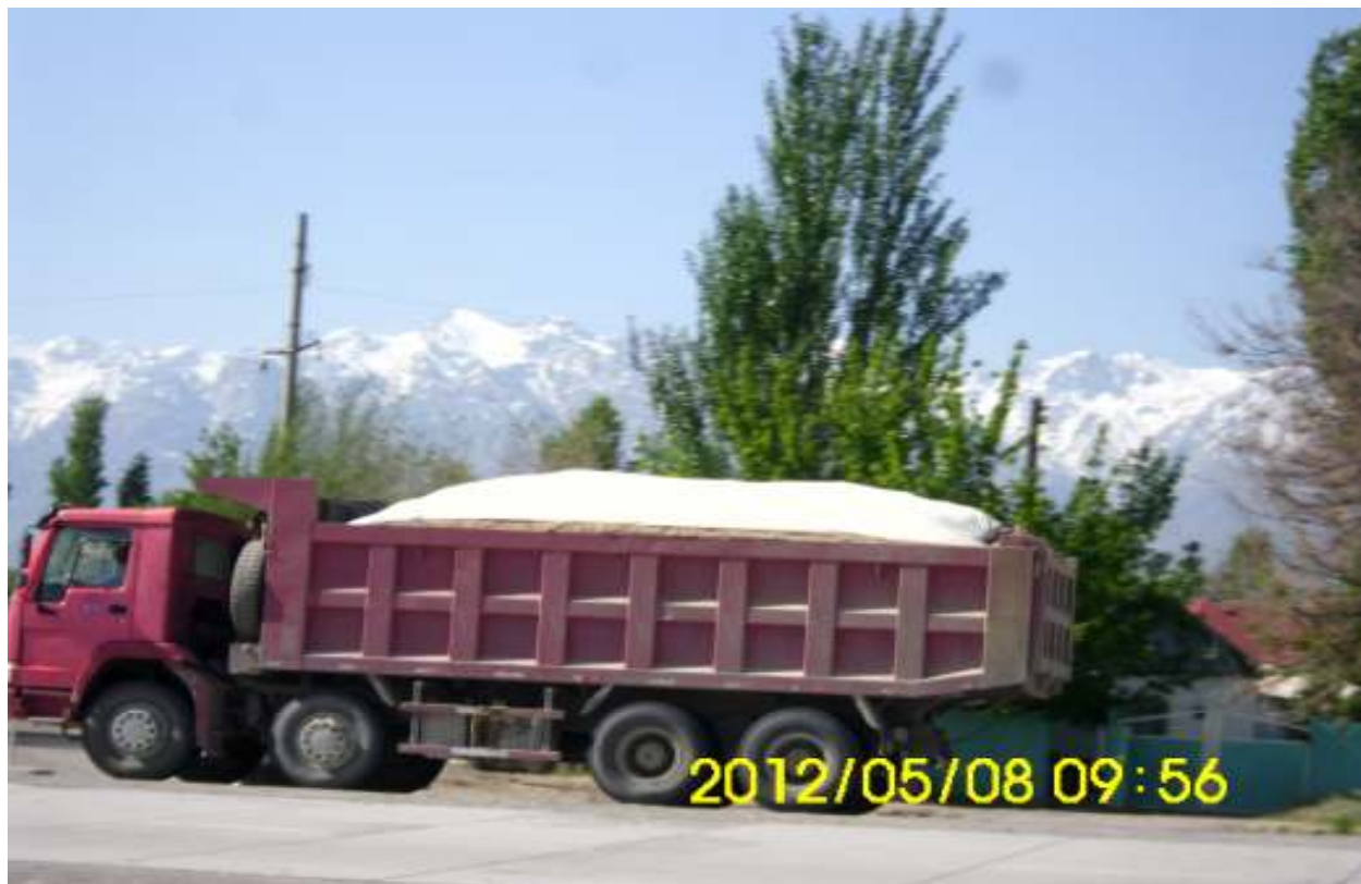
Накрытие брезентом инертных дорожно-строительных материалов (май 2012 г.)
